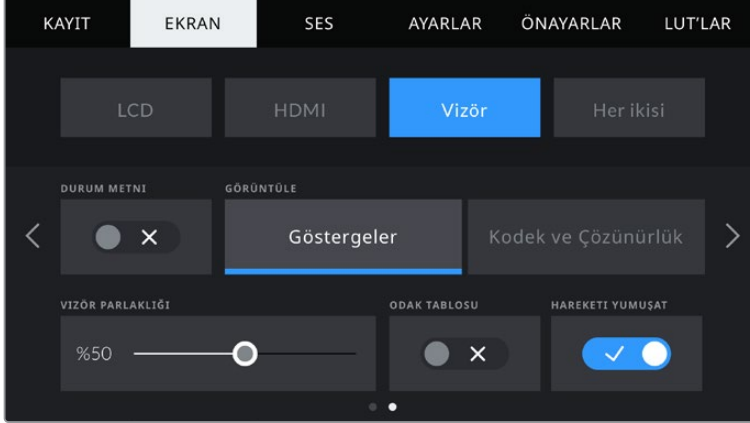
Vizör için ayarlar ile Pocket Cinema Camera 6K Pro'daki 'ekran' sekmesinin 2. sayfası
