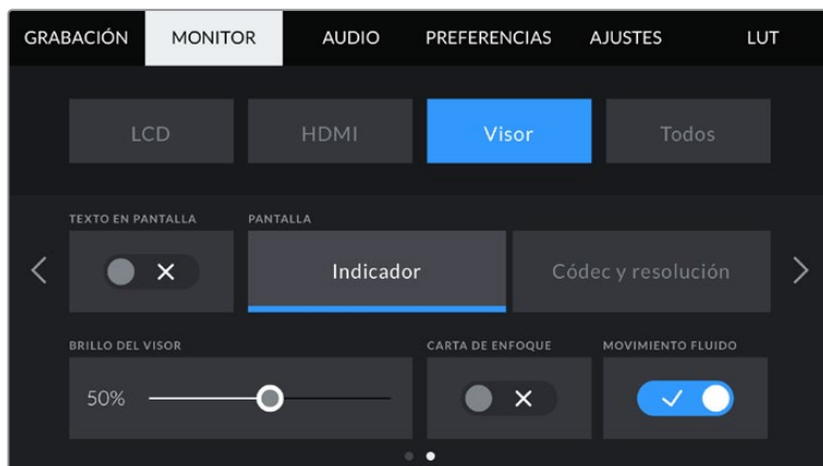
Segundo grupo de ajustes de la pestaña MONITOR en el modelo Pocket Cinema Camera 6K Pro con opciones para el visor
