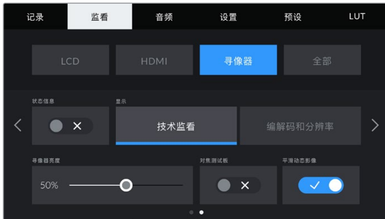
Pocket Cinema Camera 6K Pro机型“监看”选项卡第二页上的寻像器设置
