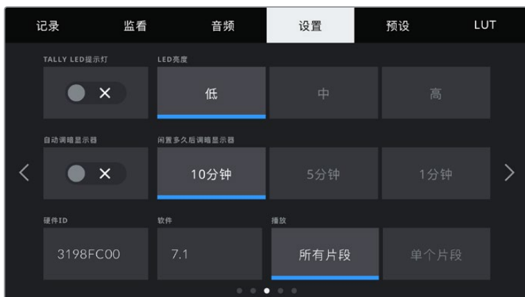
Pocket Cinema Camera 6K Pro的“设置”选项卡第三页包含闲置一段时间后自动调暗显示器的设置
