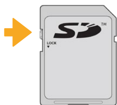
上下移动锁定开关可锁定或解锁SD卡
